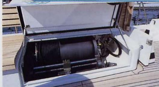
**Un grande hangar ospita perfino il battello appoggio montato. Tutti celati sotto le sedute gli otto winch idraulici**
